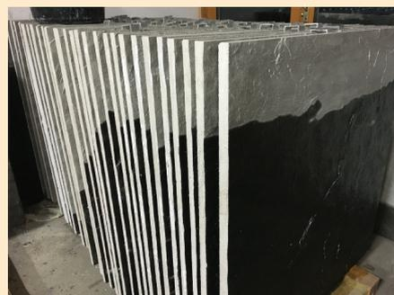
▲ 900 plaques de 82 x 82 cm ont été imprimées par Fabrice Davenne, à raison de 5 plaques par heure, pour réaliser le parement de façade final représentant une photographie de la côte vendéenne de 110 mètres de long sur 6 mètres de large. La légèreté du mortier i.design EFFIX ARCA s'est avérée un atout pour manipuler les panneaux à l'impression.
